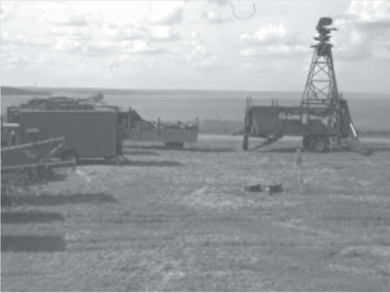
Arte 727 med operatörshydda och sensorenhet. I toppen av sensorns mast fanns radarantenn, TV-kamera och laserav-stånds-mätare. Fältmätutrustning är uppställd intill sensorn för inmätning av dess läge
