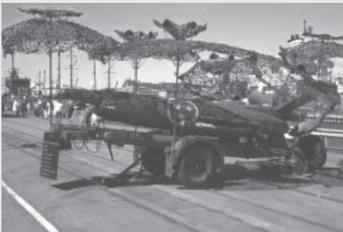
Rb 08 på sin avskjutningsramp. Roboten startades med krutgasraketer som fälldes när de brunnit ut. Därefter drevs roboten av sin turbojetmotor. Roboten var målsökande och hade stor sprängverkan i målet
